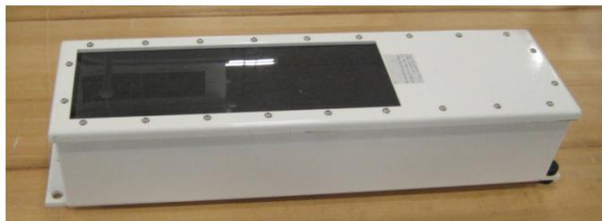
Figure 2 NaI detector module
