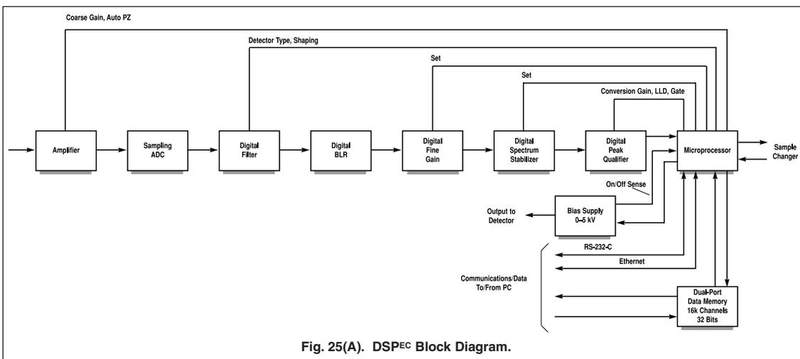
Fig. 25(A). DSPEC Block Diagram.
