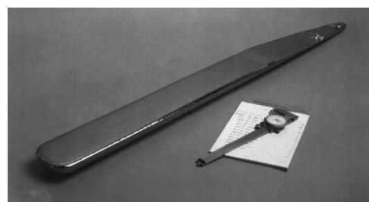
Fig. 3. A Zone-Refined Ingot.
